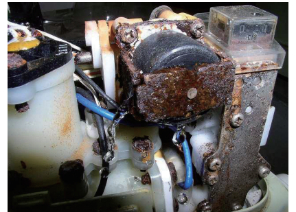
洗剤から発生したガスによる金属部品の腐食
